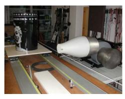
la ventola ad una certa distanza dall'asse del cilindro. Si avvia la ventola e la si sposta da un estremo all'altro delle guide sulle quali poggia il cilindro, registrando la forza dovuta all'effetto Coanda in funzione dello spostamento della ventola.
